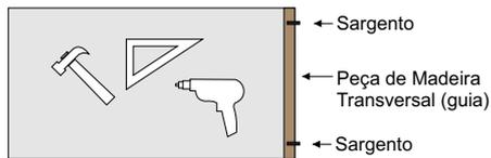
Mesa de carpinteiro ou uma chapa plana com dois cavaletes de mesma altura, esquadro de carpinteiro, furadeira, martelo, quatro pregos de aço de preferência 18x27, duas tiras de madeira de aproximadamente 600mm de comprimento para o travamento superior e uma tira de madeira de comprimento igual ao da peça horizontal para o travamento inferior.
