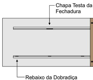
A montagem dos conjuntos de batentes deve começar por se fazer em uma das peças verticais o rebaixo para as dobradiças, que deverão ser no mínimo em número de três (03) - utilizar para instalação parafusos de aço para madeira, cabeça chata 8mm, comprimento 30mm e bitola de 04mm, e na outra o rebaixo para a chapa testa da fechadura (usar como gabarito as dobradiças e a chapa testa da fechadura a serem utilizadas no conjunto).
