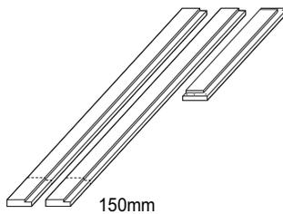
As peças verticais dos marcos/batentes Maxframe®, devem ser, desde suas extremidades próximas ou em contato com o piso até a altura mínima de 150mm, totalmente impermeabilizadas com produtos que garantam sua integridade, observando todas as recomendações do fabricante do material utilizado na impermeabilização.
