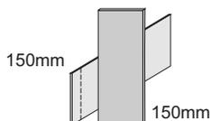
As folhas-de-portas Hardoor® devem ser, desde suas extremidades próximas as bordas horizontais até a altura mínima de 150mm, totalmente impermeabilizadas com produtos que garantam sua integridade, observando todas as recomendações do fabricante do material utilizado na impermeabilização.
