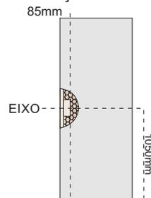
Utilizar fechadura e furação conforme norma NBR 15930-2. Quando se tratar de núcleo sólido, o cliente tem a opção de personalizar a posição da fechadura.
