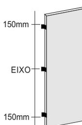
Utilizar dobradiças e parafusos conforme norma NBR 15930-2. Seguir a posição de instalação conforme a norma.
